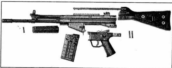
Drie borgpennen houden de Offizier bijeen. De afsluiter die hier nog in de kast zit, glijdt er vanzelf uit.
