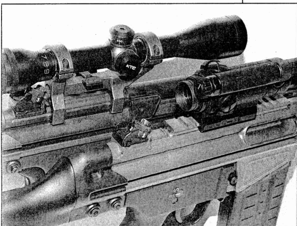
Linksboven: De gelaste rail maakt HK-montages onbruikbaar. Rechtsboven: het draagstuk moest worden ingekort. De gewijzigde afsluiter maakt montage wat lastiger. (Zie tekst.) Rechtsonder: het inkorten is maar netaan goed afgelopen. Er moest een extra oogje voor de handbeschermer worden aangebracht.
