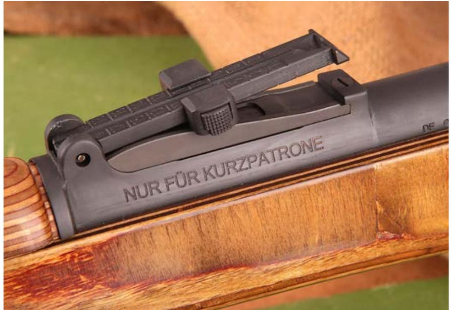
Auch auf dem Schiebevisier ist die Bemerkung „NUR FÜR KURZPATRONE“ eingeprägt. Damit soll eine falsche Munitionierung verhindert werden.
